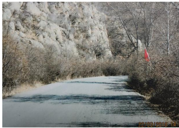
5.1-2 弯道内侧视距植被遮挡视距示意图
