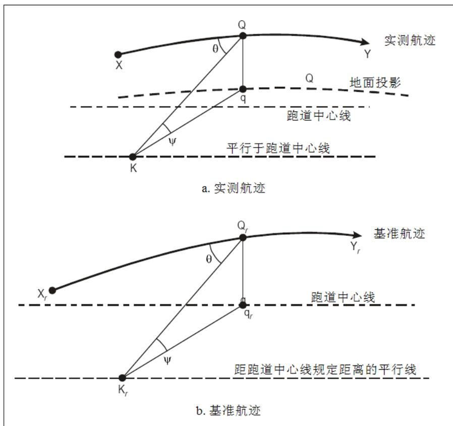
图 A36-7 横向测量 - 基准测量站的确定
