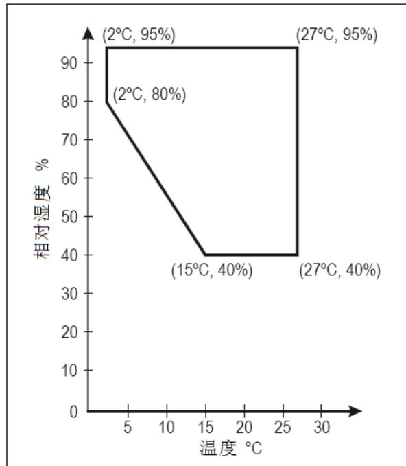
图 G1 不需吸声修正的测量窗口
