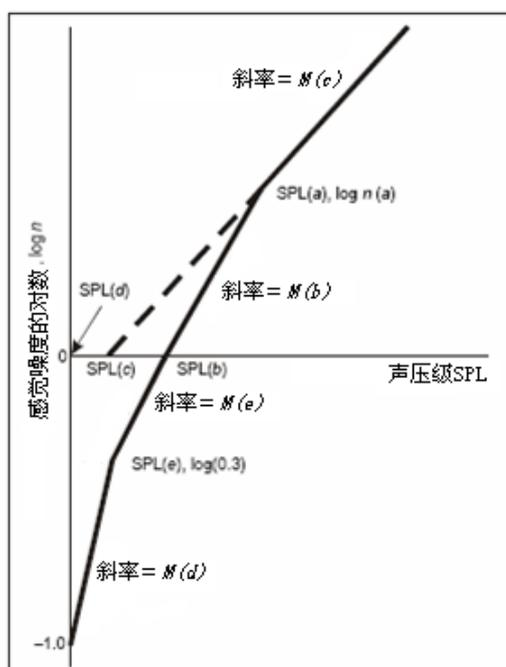
图 A36-3 作为声压级函数的感觉噪度
