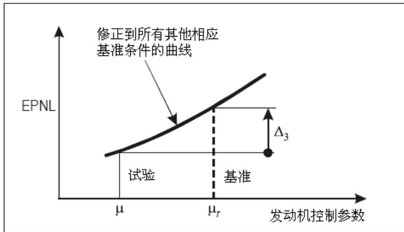
图 A36-8 噪声推力修正
